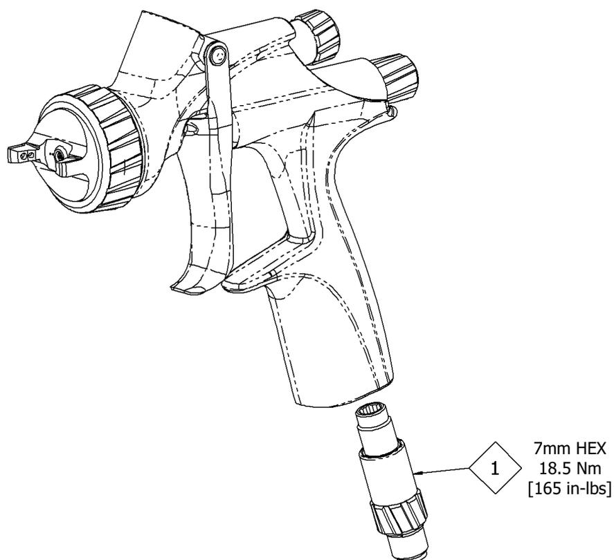
**DESMONTAJE DE LA VÁLVULA DE AIRE**
