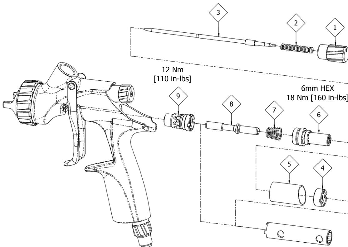
PARA CAMBIAR EL MANGUITO DE IDENTIFICACIÓN ÚNICAMENTE
