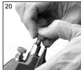
20. Installer le ressort (8) et le bouton (7).
