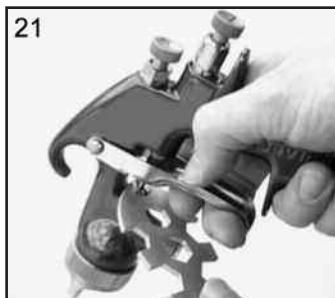
21. Ajuste la empaquetadura de la aguja (4) con una llave lo suficiente para hacer sello pero permitiendo que se desplace la aguja. Lubrique con aceite para pistolas.
