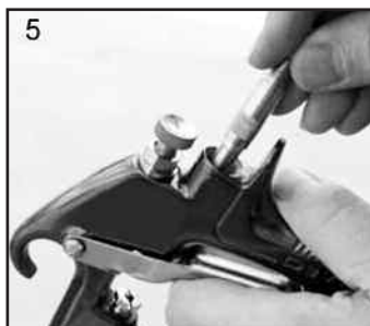
5. À l'aide de l'outil d'entretien SPN-7, saisir la rainure derrière le support de la soupape.
