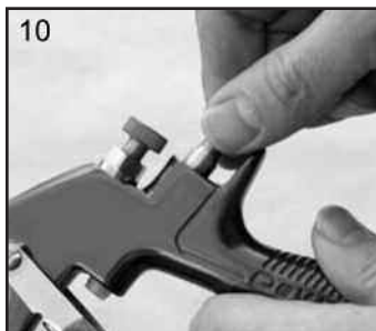
10. Installer le nouveau joint au corps de la soupape et appuyer fermement pour s'assurer que le joint est bien en place.
