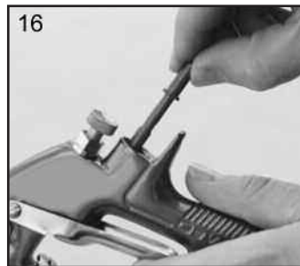
16. Remettre la soupape en place (11).
