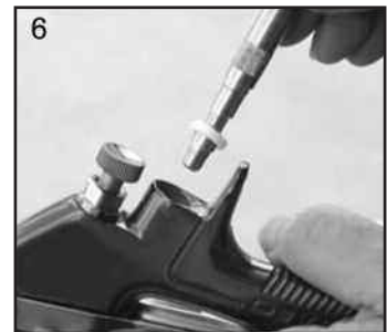
6. Retire el asiento de la válvula.
