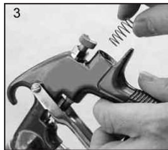
3. Retirer le boîtier (10) et le ressort de la soupape d'air.
