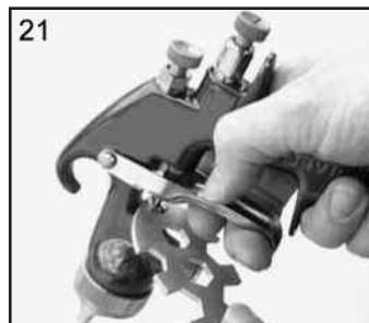
21. Resserer la garniture d'étanchéité du pointeau (4) à l'aide des tricoises suffisamment pour bien sceller, mais tout en permettant le libre mouvement du pointeau. Lubrifier à l'aide de lubrifiant à pistolet pulvérisateur.
