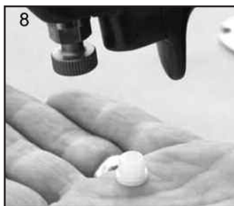
8. Retourner le pistolet et laisser le joint tomber.
