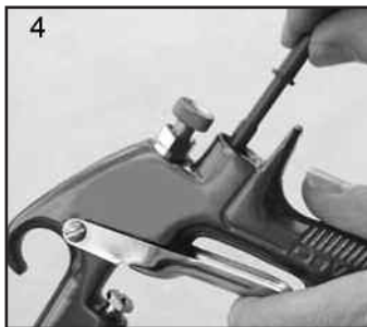
4. Retire la válvula (11).
