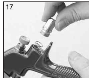
17. Remettre le ressort de la soupape en place et visser au boîtier (10).
