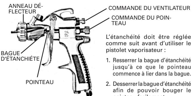
La bague d'étanchéité est réglée intentionnellement de manière lâche afin que le joint de PTFE ne se tasse pas trop avant que le pistolet vaporisateur ne soit utilisé. Cela permet un usage optimal du joint.
